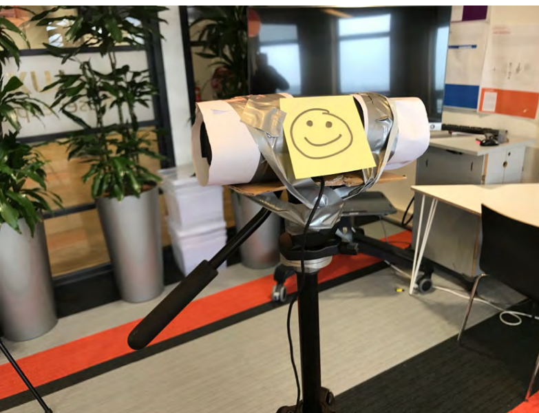
Figuur 5. Het prototype van de praatpaal: speaker op fotostatief.
